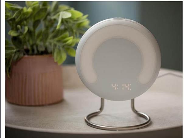
El Halo Rise no tiene acelerómetro ni sensor óptico de frecuencia cardíaca. Al igual que el Nest Hub, rastrea el sueño a través de un radar de bajo consumo que analiza tu movimiento y tu respiración. A diferencia del Nest Hub, no tiene micrófono, por lo que no graba sonidos. Tampoco tiene cámara.
